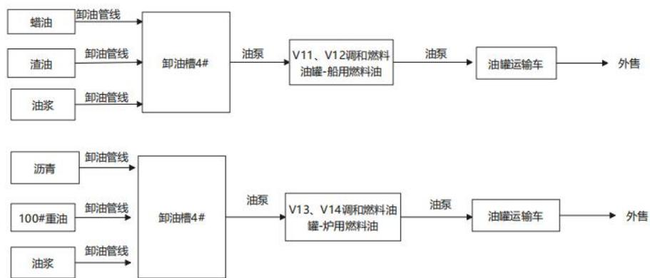
图 2-2 调和燃料油物料流程图
